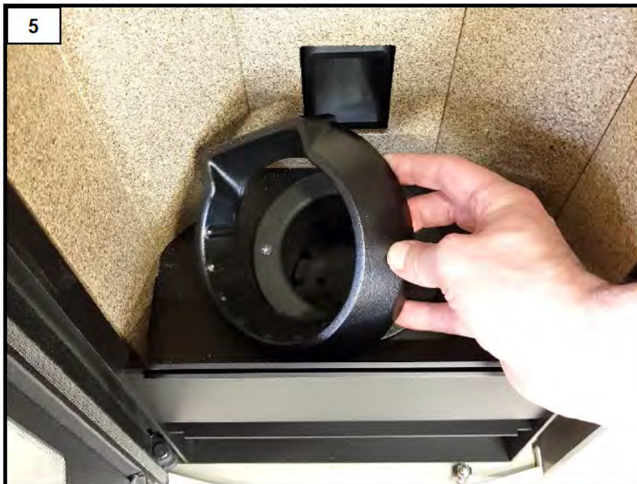
Fjern brandskålens dækring og fjern forbrændingsresterne (figur 5).
