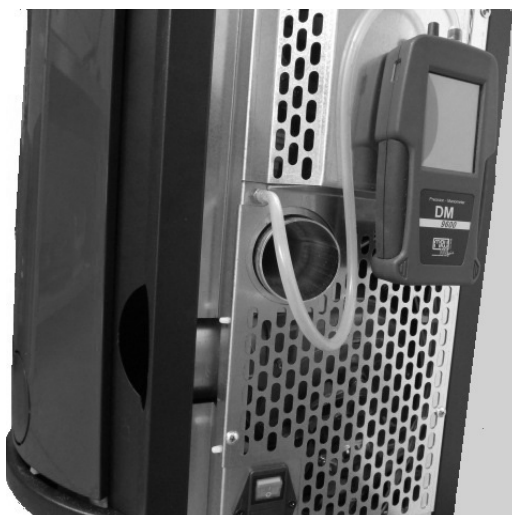
Fig. 55 - Tilslutning af digital trykmåler
