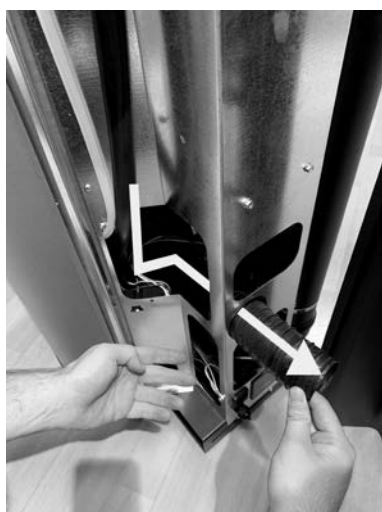
Fig. 55 - Åbning fleksibelt rør 1
