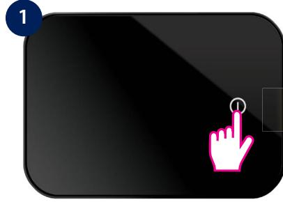
Tryk på tænd/sluk-knappen ① for at oplyse skærmen.
