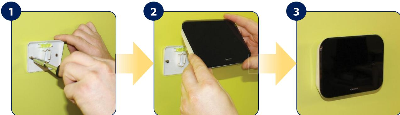
Fastgør vægmonteringsbeslaget til en passende væg ved hjælp af de medfølgende beslag.
