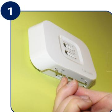
Brug en tynd genstand (såsom en papirclips) til at trykke og holde SYNC-knappen i bunden af iT500RX-modtageren nede i 5 sekunder.
