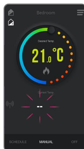
For at løse det skal du parre iT300-termostaten og indstille to-zonetermostatens driftstilstand igen. Fejlen forsvinder.
