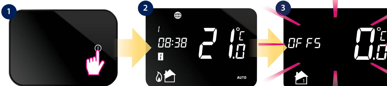
Tryk på tænd/sluk-knappen ① for at oplyse skærmen.
