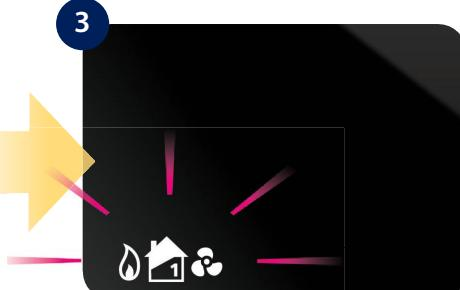
Brug -knappen til at søge mulighed for varme/køling. Bekræft med -knappen.
