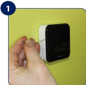
Brug en papirclips til at holde knappen, som er placeret i hullet på iT300-huset, nede i 3 sekunder.
